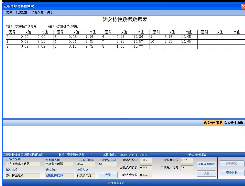
图 6.1.3 CT 伏安特性试验结果显示
