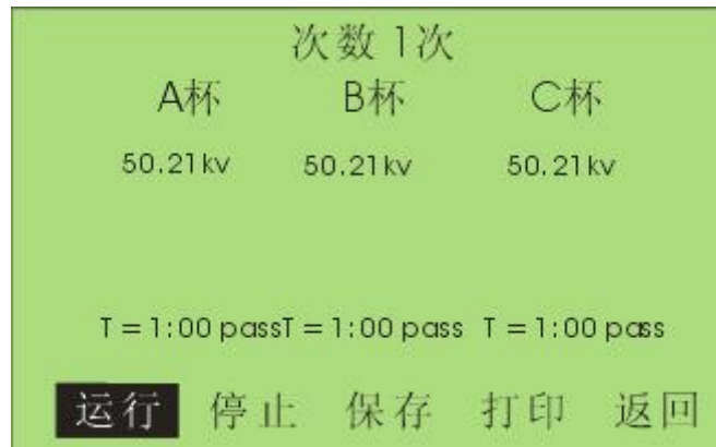
图 2.6 油耐压试验完成界面
