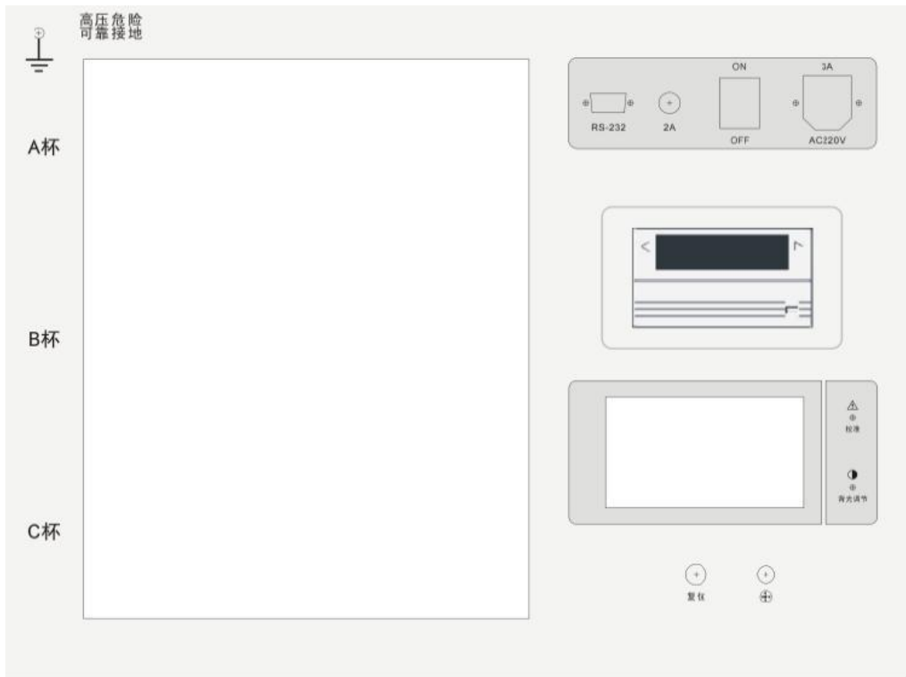
图 1.1 绝缘油介电强度测试仪面板
