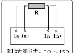
阻抗测试:  $0\Omega \sim 15\Omega$
