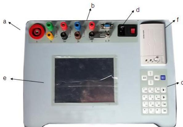
a、低校高电压互感器测试接线柱:
