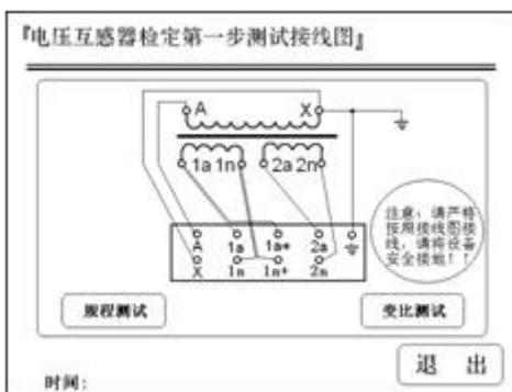
接线完成确认无误后请选择相应按钮进入电压互感器测试数据界面或变比测试界面。首先参照界面显示的接线图接好测试线路，测试导线请使用厂家配备的专用测
